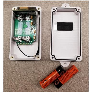
4. Remplacez les piles en vous assurant qu'elles sont bien placées--faites correspondre le + et le - indiqués sur le tableau du dispositif avec le + et le - de vos piles.
