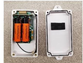
2. Retirez les 2 piles AA 3,6 V du dispositif.
